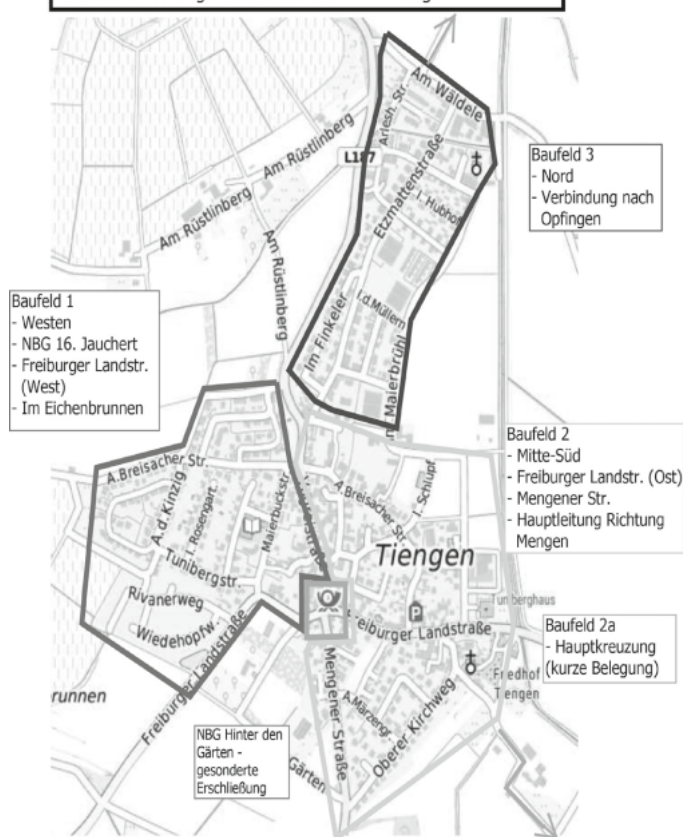
Baufeldereinteilung Glasfaserausbau in FR-Tiengen
